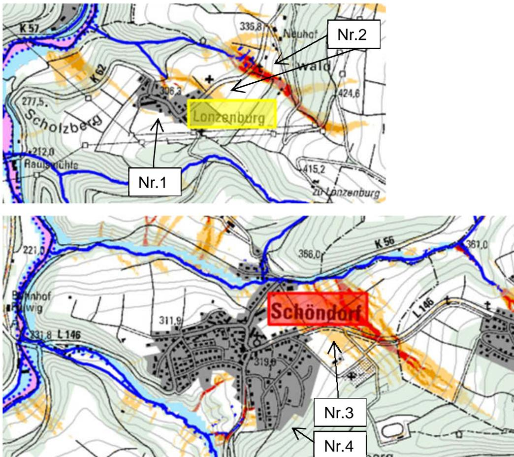
**ABBILDUNG 4: KARTE „GEFÄHRDUNGSANALYSE STURZFLUT NACH STARKREGEN“ DES LFU MIT EINEM AUSSCHNITT DER ORTSGEMEINDE SCHÖNDORF MIT NUMMIERUNG DER STANDORTE DER HOHEN ABFLUSSKONZENTRATIONEN (QUELLE: LFU)**
